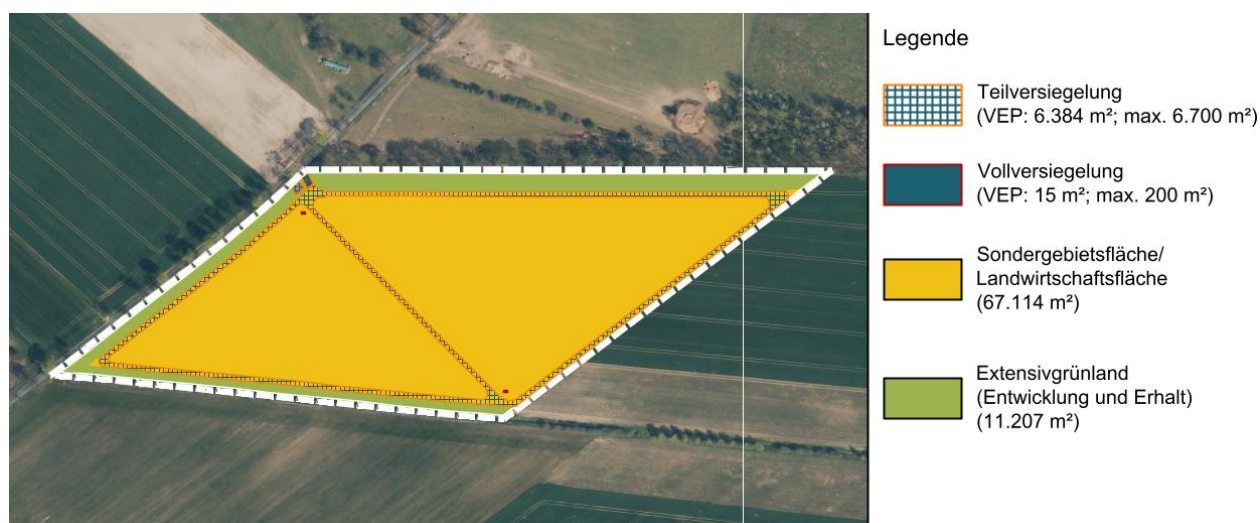
Abbildung 47: Schutzgut Boden Versiegelungsgrad Planung , o. M.
